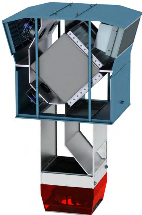
Предназначены для устранения эффекта стратификации (температурного расслоения) воздуха в помещениях с высокими потолками (от 4 до 35 метров), результатом которого является значительная разность температур воздуха в разных зонах помещения: у пола и под потолком, у внутренней и у наружной стены, что увеличивает расходы на отопление, создает дискомфорт. Системы укомплектованы перекрестно-точным рекуператором.
